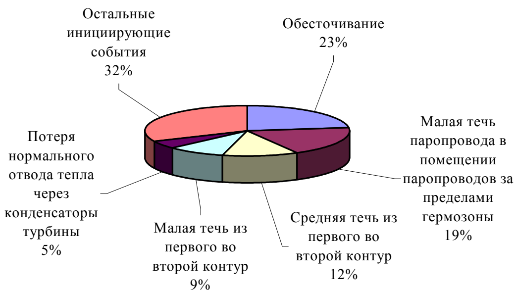
Рис. 1. Вклады в частоту повреждения активной зоны при работе реактора на мощности от инициирующих событий для второго варианта ППР систем безопасности
